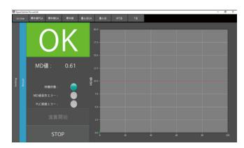
自動判定機能はSignalCatcherで作成した特徴抽出方法を使い自動でMT法を演算できる機能です。データロガーやPLC等から出力されてくる測定データの更新をトリガーとし計算を開始します。PCとPLCを接続すれば、結果を設備に返すこともできます。
